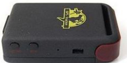
Rysunek 27. Lokalizator GPS. Urządzenie odczytuje swoje położenie na podstawie sygnału GPS i na bieżąco wysyła je do serwera
