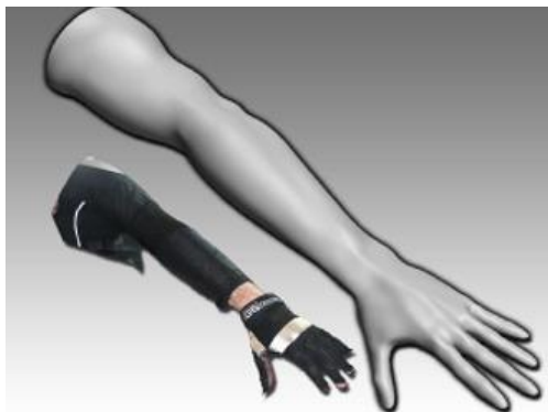
Rysunek 19. Wykonana z lycry rękawica typu Inertial. Charakterystyczny brak widocznych elementów sterowania
